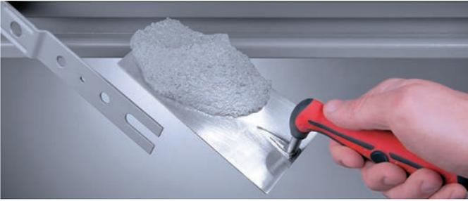
Nel caso di fissaggio con zanche, si consiglia di creare gli scassi adeguati nella parete (sezione 80 x 200 mm). Le zanche vanno ripiegate e bloccate nella parete. Ai fini della tenuta al fuoco e della tenuta meccanica, il vuoto tra telaio e muratura deve sempre essere riempito con malta cementizia.
