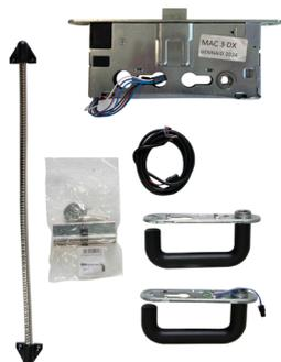
Compreso (fornito in imballo): serratura antipanico a tirare MAC3 entrata 65mm con magnete incorporato, riscontro serratura in plastica nera, scheda elettronica con temporizzatore, cavo 4 fili, passacavo, maniglia a doppia leva (plastica nera). Led rosso/verde applicati su una delle placche, quadro sdoppiato, viti di fissaggio, cilindro nichelato standard, pittogramma adesivo (freccia verde).
