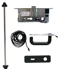
Compreso: serratura antipanico a spingere MAC1 con solenoide incorporato, scheda elettronica con temporizzatore, cavo a 4 fili (da far passare attraverso il maniglione o attraverso la canalina per maniglia M3), passacavo, maniglia BM o M3 (plastica nera) con applicati led rosso/verde. Escluso: maniglione antipanico Ninz.
